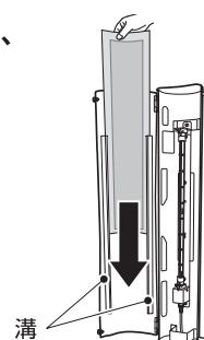
※挿し込みにくい場合は、専用粘着シートを曲げると挿し込みやすくなります。
