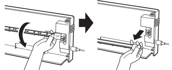
ランプの両端に手を添え、本体下部に向かって90度回し真っ直ぐに手前に引き抜きます。※古いランプは各自治体の廃棄方法に従って処分してください。
